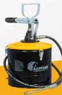
EM CHAPA DE AÇO, ALTA PRESSÃO. CAPACIDADE: 7KG | GRAXA ATÉ NLGI2 | ACIONAMENTO: ALAVANCA | PRESSÃO DE TRABALHO: 3.000PSI | ACOMPANHA: MANGUEIRA Ø 1/4", COMPRIMENTO 1.3M / EXTENSÃO RÍGIDA / ACOPLADOR / COMPACTADOR COM MOLA
