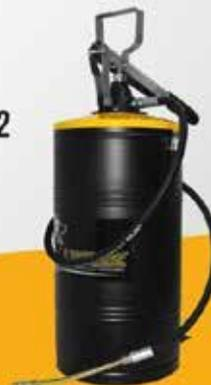
EM CHAPA DE AÇO, ALTA PRESSÃO. CAPACIDADE: 15KG | GRAXA ATÉ NLGI2 | ACIONAMENTO: ALAVANCA | PRESSÃO DE TRABALHO: 4.000PSI | ACOMPANHA: MANGUEIRA Ø 1/4", COMPRIMENTO 1.3M / EXTENSÃO RÍGIDA / ACOPLADOR / COMPACTADOR COM MOLA
